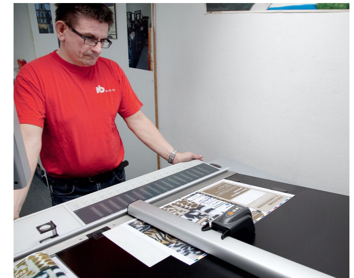
Heute: Mit Prinect Easy Control wird der Prozess messbar und nachvollziehbar, der Verlauf der Farbführung lässt sich am Monitor genau mitverfolgen. Reto Badertscher hat die Fortdruckmakulatur praktisch auf Null reduziert.
