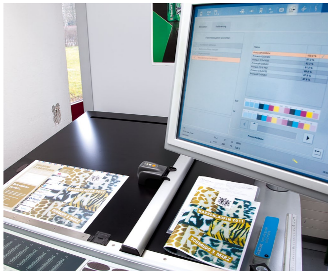
Prinect Easy Control ist in den Leitstand Prinect Press Center integriert und nutzt die von Prinect Axis Control und Prinect Inpress Control her bekannte Plattform mit identischer Bedienungsführung am Touch-Screen.
