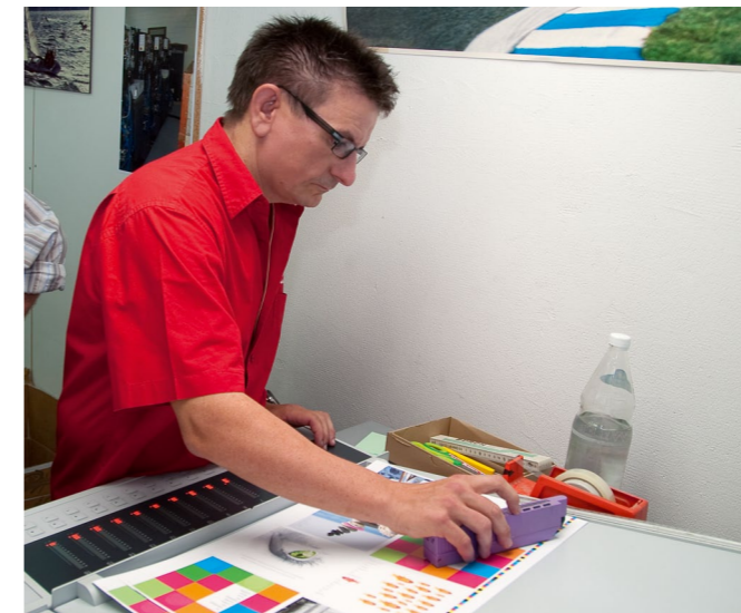
Früher: Das Ausmessen der Druckkontrollstreifen mit dem Handmessgerät ist schwerfällig, unzuverlässig und erfordert viel Disziplin und Aufwand. Die genügende Stabilität der Farbführung über die Auflage hinweg ist nicht gesichert.
