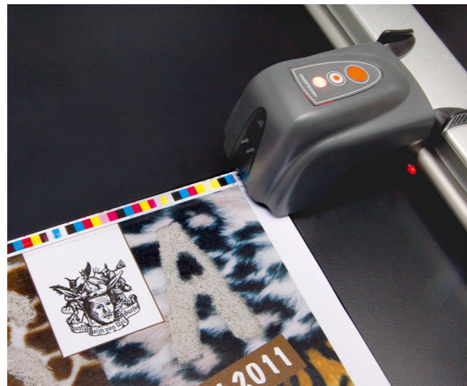
Eine im Messkopf integrierte Laserprojektion unterstützt den Drucktechnologen beim einfachen manuellen Positionieren des Messgeräts vor der Freigabe des automatischen Messvorgangs.
